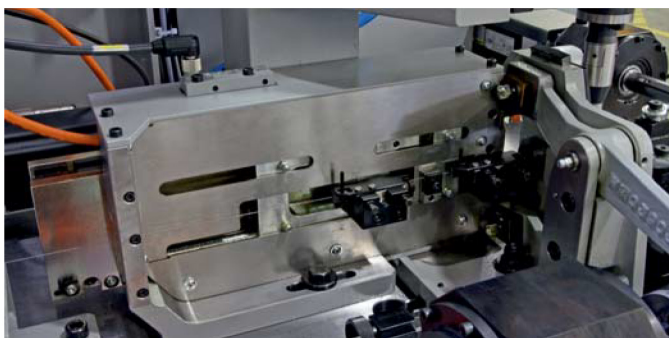
▼ リニアモーターによるスライド送り装置
