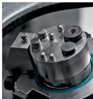
▲ フリーフォームベンディングも可能なマルチベンディングツール
