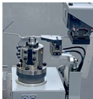
▲ ベンディングツールと連動したスイベルアーム及びグリッパー (上部ヘッド)
