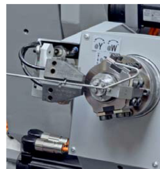
▲ ベンディングツールと連動したスイベルアーム及びグリッパー (下部ヘッド)
