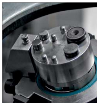
▲ フリーフォームベンディング用のマルチベンディングヘッド
