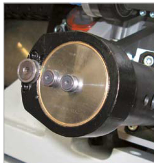
▲ オプション - ベンディングヘッドのオフセンター移動により多様なツールコンセプトを使用可能
