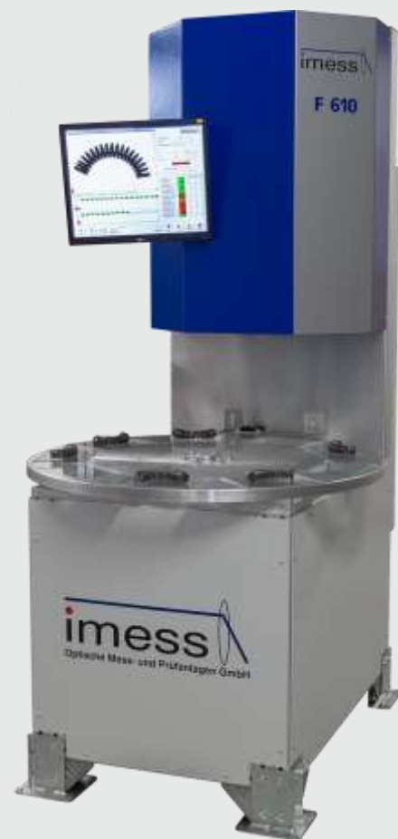
回転ディスクは、カメラモジュールの下にあるアークスプリングを動かす。
