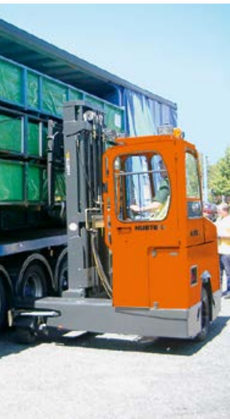
Vierwege-Universalstapler mit Diesel- oder Gasantrieb Diesel- or LPG-powered Fourway-Sideloader
