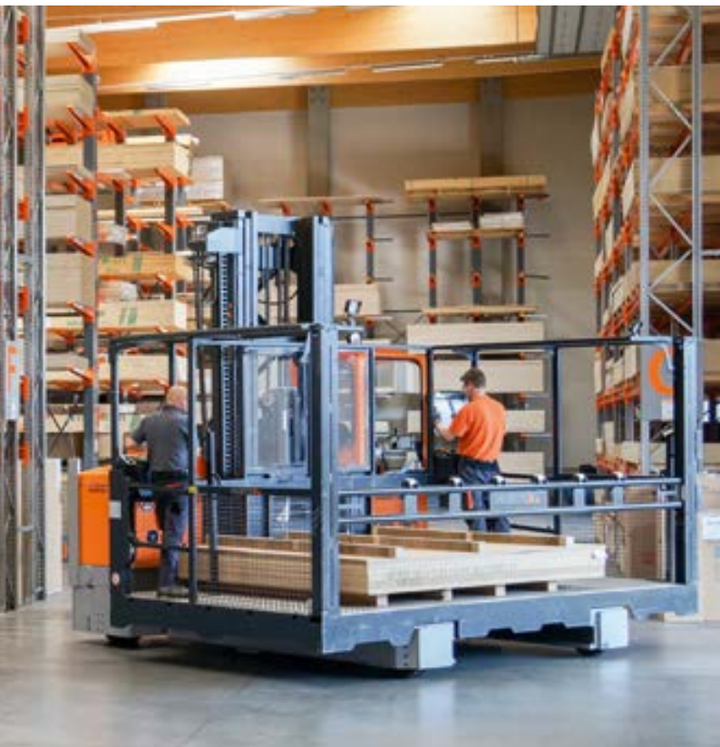
Mehrwege-Seitenstapler mit aufnehmbarer Kommissionierplattform Multidirectional-Sideloader with removable order picking platform
