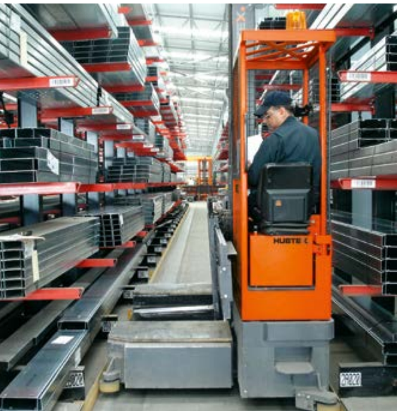
Mehrwege-Seitenstapler mit Längssitzkabine Multidirectional-Sideloader with longitudinal seat cabin
