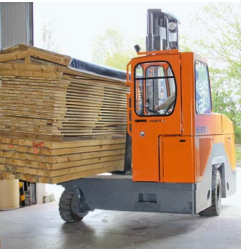
Vierwege-Seitenstapler, Tragfähigkeit 6 – 8 t Fourway-Sideloader, capacity 6 – 8 t
