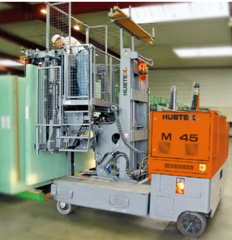
Mehrwege-Seitenstapler für das Handling von unverpackten Glaspaketen Multidirectional-Sideloader for handling of unpacked glass packs
