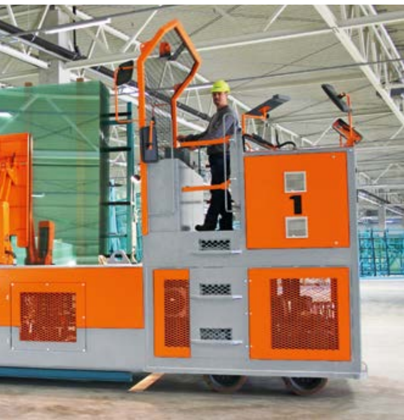
Glasgestelltransporter mit Elektro-, Diesel- oder Gasantrieb Electric, diesel- or LPG-powered Glass-frame-transporters
