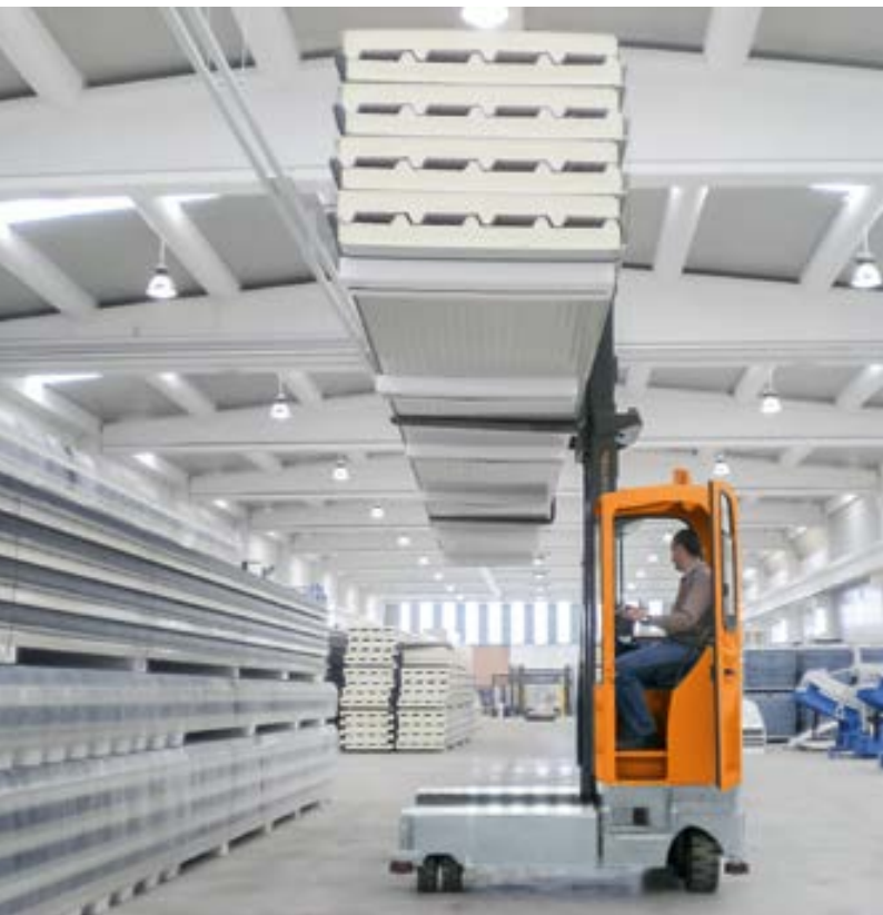
Weichbereifter Elektro-Mehrwege-Seitenstapler Electric-Multidirectional-Sideloader with soft tyres
