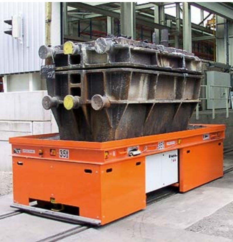
Gleiswagen zum Transport von Gussformen Rail car for mould transport
